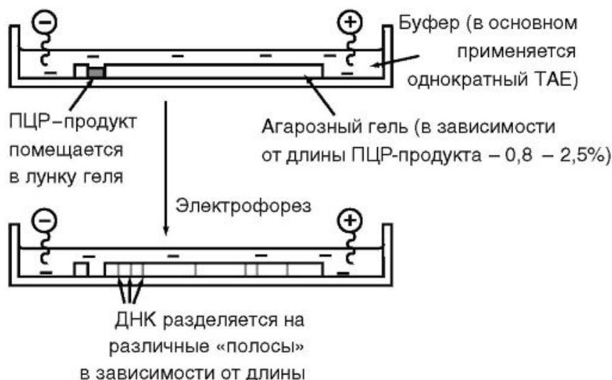
**Рисунок 6.6** - Устройство горизонтальной электрофоретической камеры
